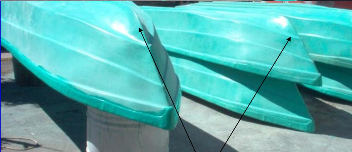
Se llama picuda debido a que la quilla de la lancha tiene forma de cuchilla para abrir el agua.
